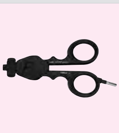
33149 Пластмассовая рукоятка CLICK'line, аксиальная, поворотная, без кремальеры, обе ручки подвижны НОВИНКА
